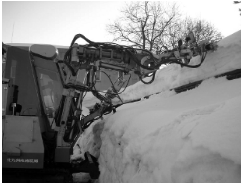
図3 多自由度アームを有する大型レスキューロボット「援竜」による積雪除去実験の様子(長岡市, 2006年2月3日)
