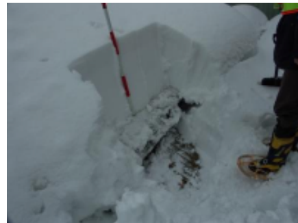
b) 倒壊した屋根部分の積雪の様子。深さ約1m。
