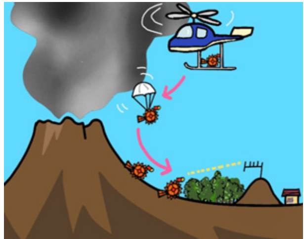
図6 飛行ロボットと小型移動ロボットによる観測シナリオ
