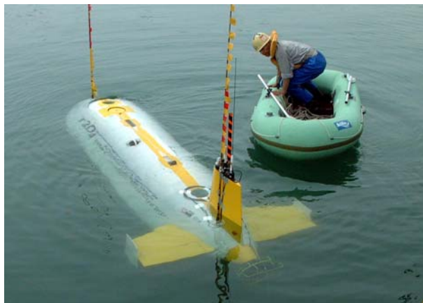
海面に降ろされ、これから潜航試験をしようとする「r2D4」
