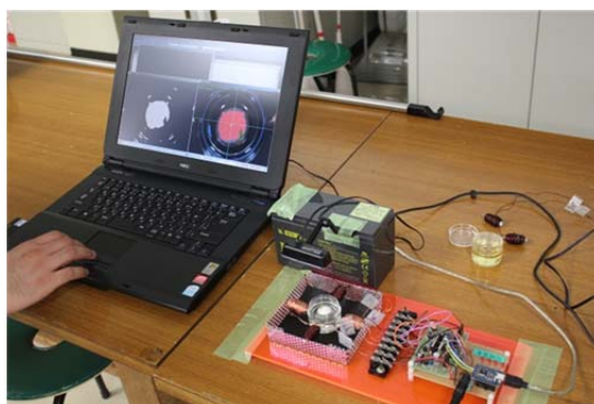
(b) 実演中の簡易磁気テザーキット完成品
