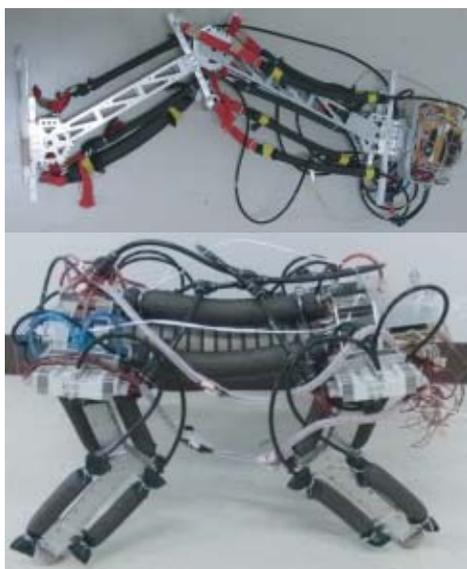
空気圧人工筋により駆動する柔
